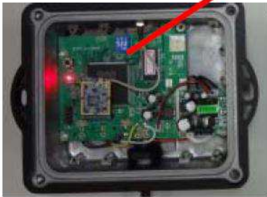
Рис.8 Расположение DIP-переключателя внутри устройства.
