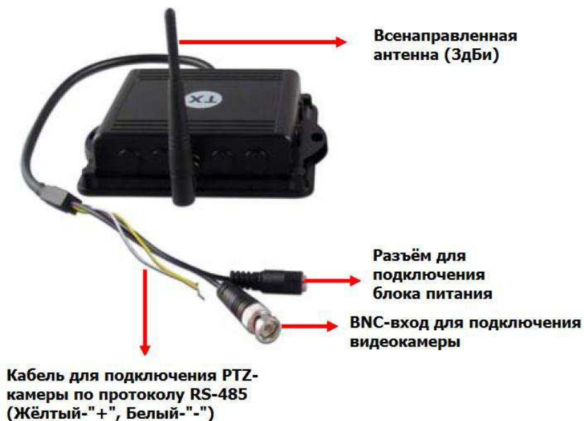
Рис.4 Панель подключения WT2.4/5(W).
