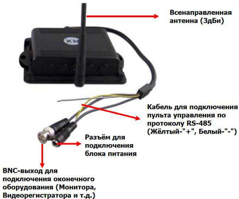
Рис.5 Панель подключения WR2.4/5(W).
