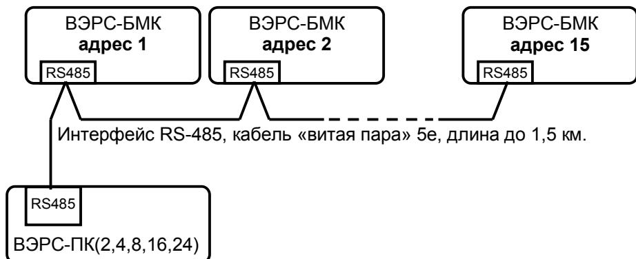
Рисунок А 4. Структурная схема связи
