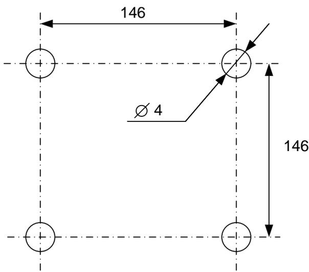
Рис. 6.1. Разметка крепления
