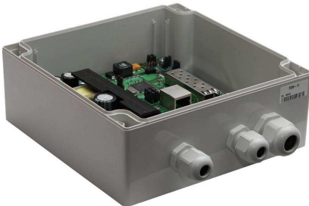
Рис. 2.1-2. PSW-11 - вид внутри
