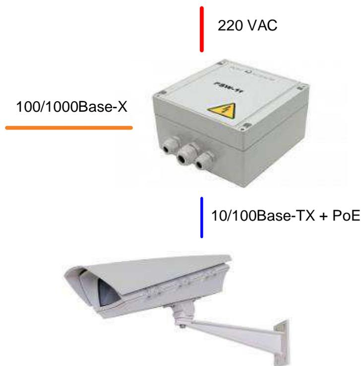
Рис. 1. Схема подключения PSW-11
