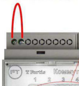
Контакты автоматической перезагрузки видеокамер
