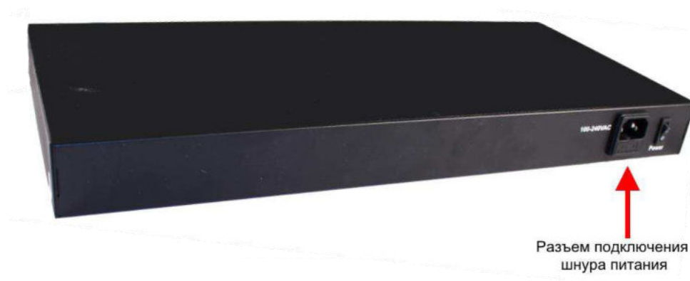
Рис. 6 Коммутатор SW-62422/B(330W), разъемы на задней панели
