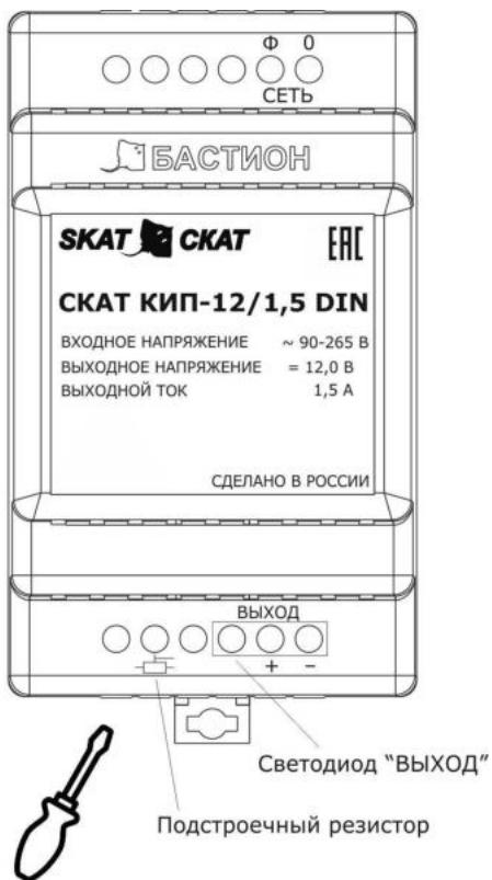
Изделие имеет в своём составе подстроечный резистор (рисунок 2), позволяющий при помощи отвёртки регулировать уровень выходного напряжения в пределах, указанных в таблице 1.
