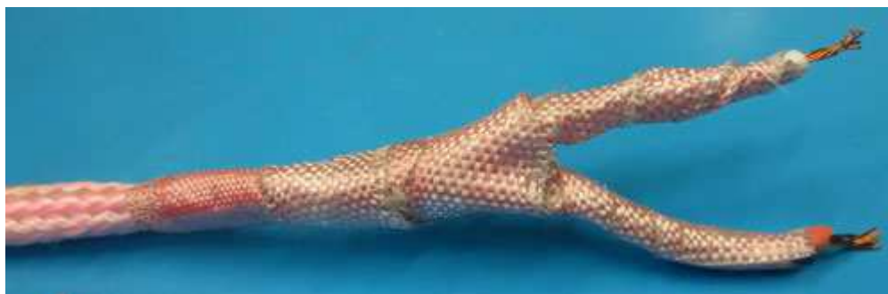
Рис. 23. Пример разделки кабеля.
