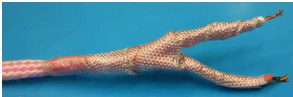
Рис. 23. Пример разделки кабеля.
