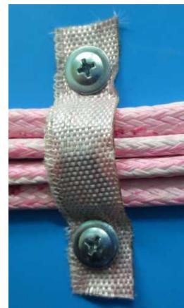
Рис. 6. Установка дюбель–хомута КФСТ.735322.041 и КФСТ.735322.164. Вариант 2.
