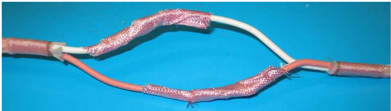
Рис. 28. Изоляция кабеля лентой термостойкой ЛТ «Гефест».
