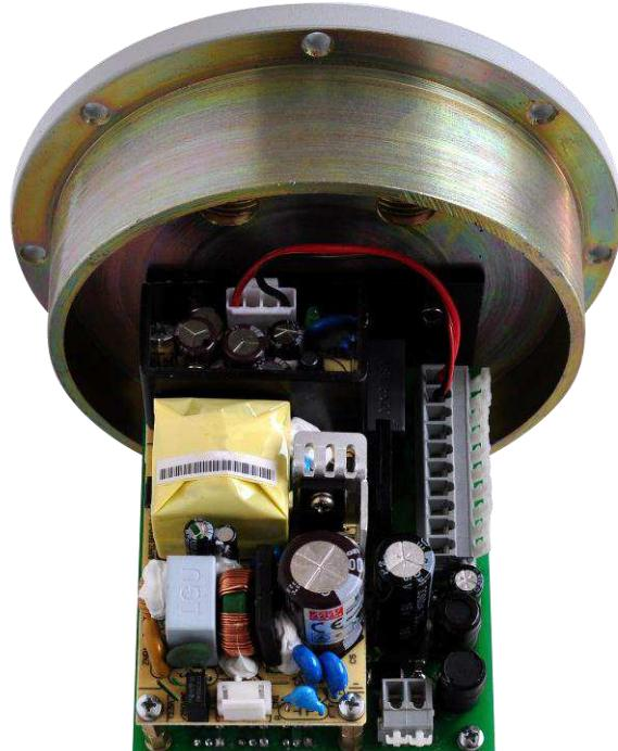
Рисунок 4 – Клеммная плата термокожуха
