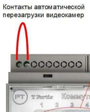
Рис. 2.5. Включение функции перезагрузки видеокамер
