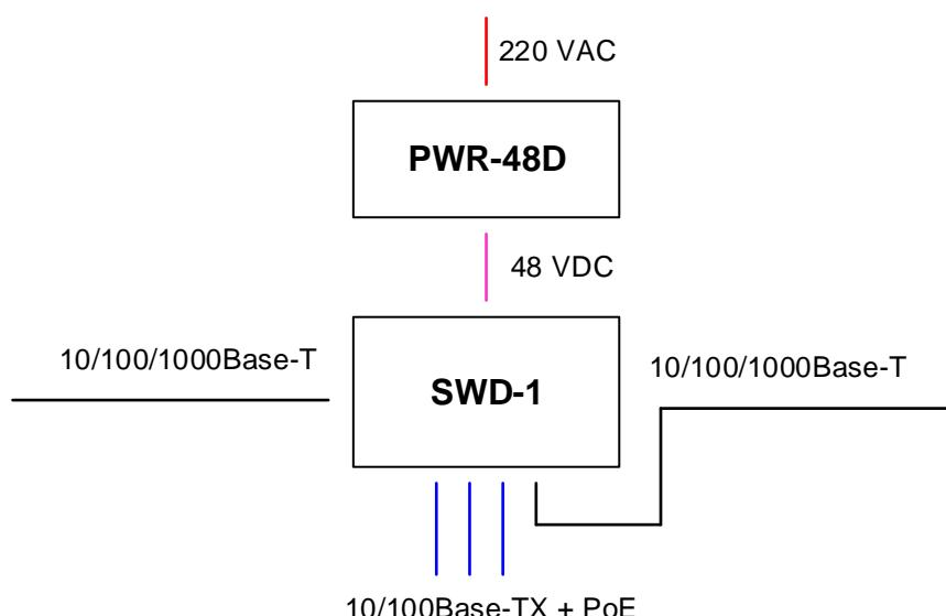
Рис. 1-2. Схема подключения 3-х видеокамер с организацией гигабитного проходного соединения
