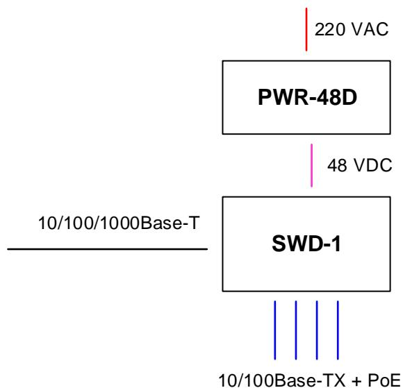
Рис. 1-1. Схема подключения 4-х видеокамер
