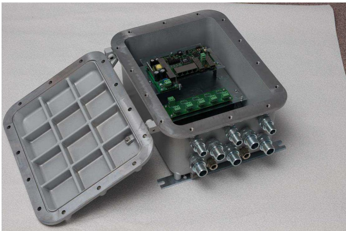
Рис. 2.1-2. PSW-2G4F-Ex - вид внутри
