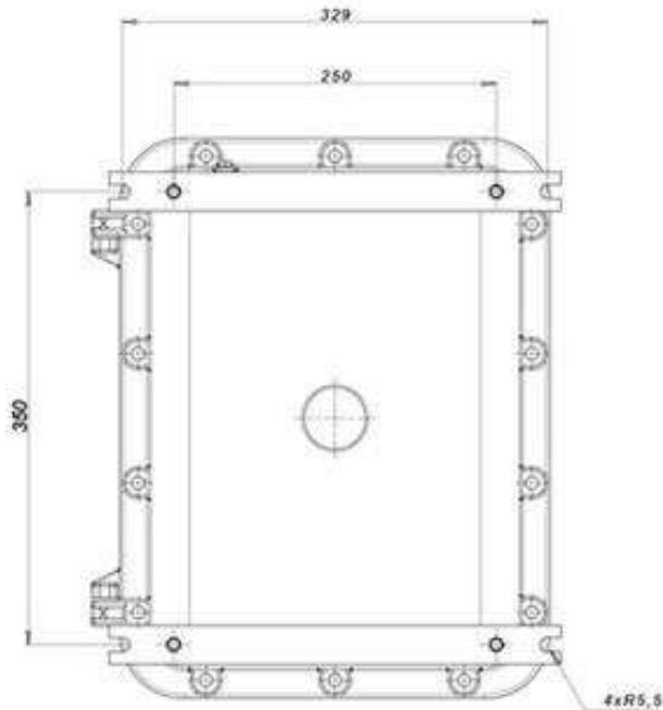
Рис. 6.1. Разметка крепления
