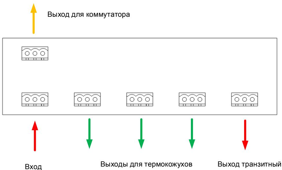
Рис. 2.5-1. Назначение разъемов
