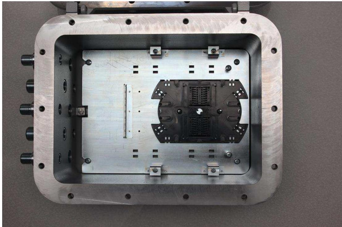
Рис.2.4. Оптический кросс
