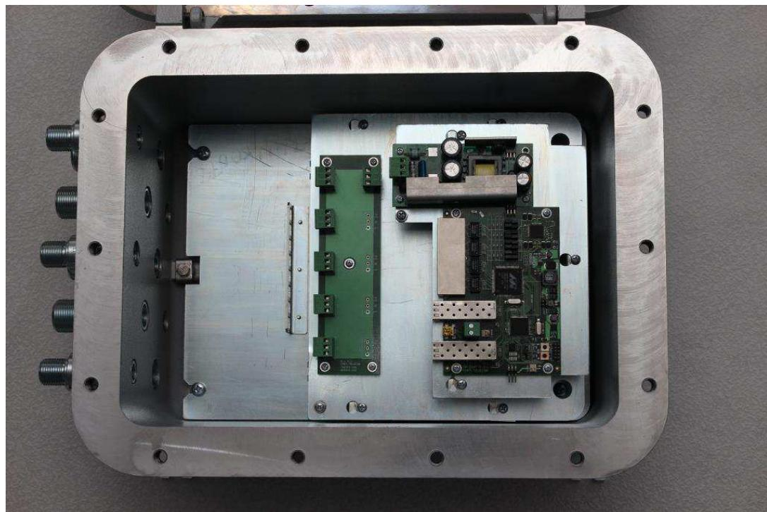
Рис.2.6-1. Плата коммутатора
