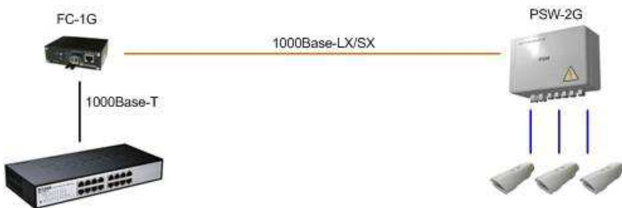
Рис. 2.3-6. Подключение PSW-2G с помощью FC-1G
