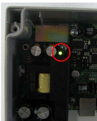
Рис. 2.7.1-1. Индикатор PWR на блоке питания
