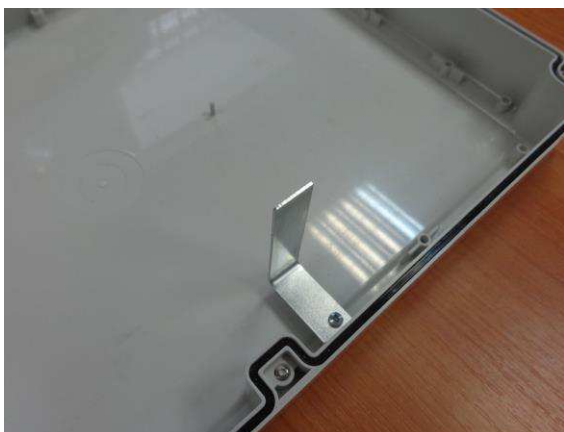
Рис. 2.5-2. Шторка датчика вскрытия на крышке блока
