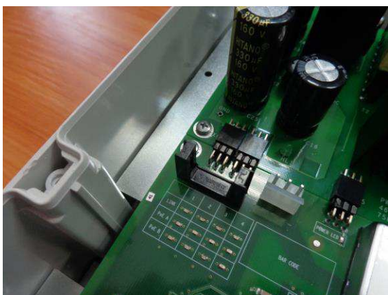
Рис. 2.5-1. Датчика вскрытия на плате
