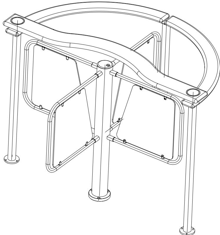
Стойки формирователя прохода — шлифованная нержавеющая труба Ø50 мм, поручни — бук (ясень), массив, мнемонические блоки индикации.
