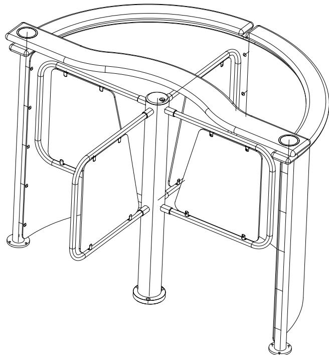
Стойки формирователя прохода — шлифованная нержавеющая труба Ø50 мм; поручни — бук (ясень), массив; заполнение — поликарбонат листовой тонированный; мнемонические блоки индикации.
