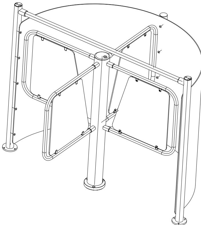
Стойки формирователя прохода — шлифованная нержавеющая труба Ø50 мм, поручень — шлифованная нержавеющая труба Ø32 мм, заполнение — поликарбонат листовой тонированный, символные блоки индикации.
