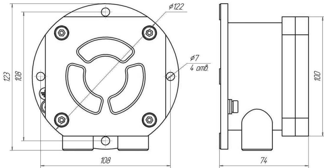
Рисунок 1 – Оповещатель пожарный взрывозащищенный световой
