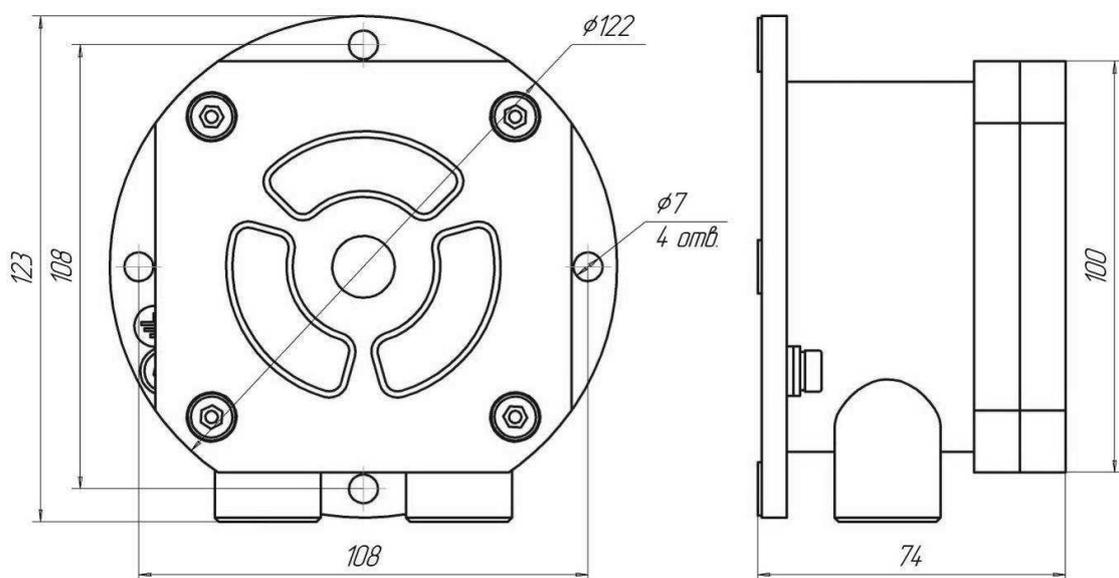
Рисунок 3 – Оповещатель пожарный взрывозащищенный комбинированный
