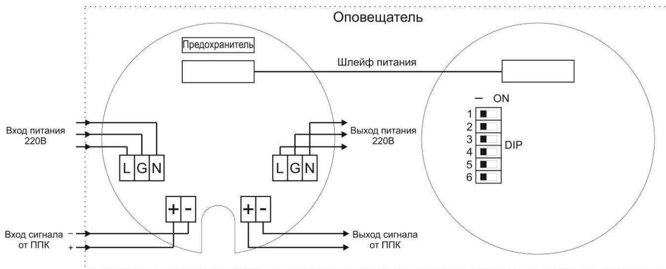
Рисунок 6 – Схема подключения оповещателя с питанием 220В
