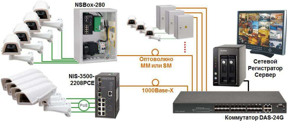
Рис. 1.Электрическая схема Узла доступа NSBox-280-R
