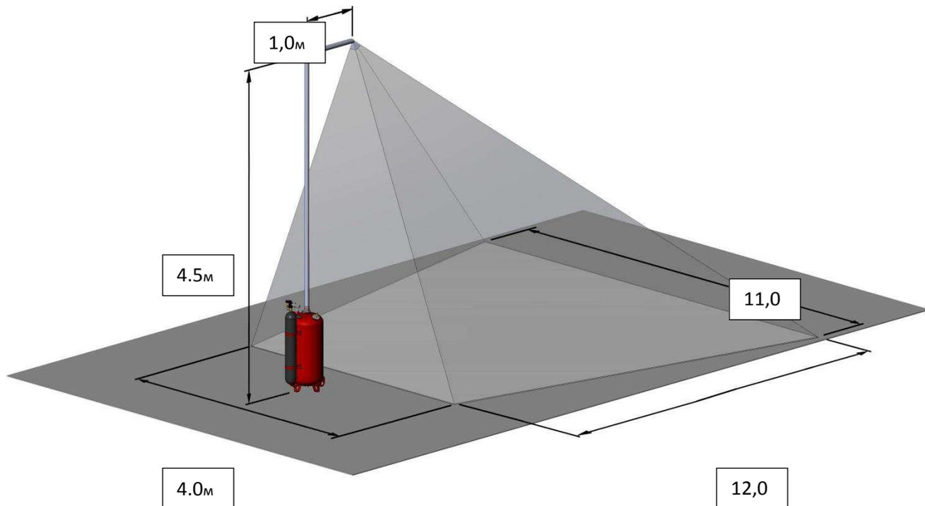
Рис.2 Варианты диаграмм распыла МПП-«Гарант-100вз» с мононасадками различного назначения ( $D_y = 50$  мм) при ориентации под углом  $180^{\circ}$ ,  $90^{\circ}$  и  $45^{\circ}$ . Для остальных случаев ориентации проводятся тригонометрические расчеты.
