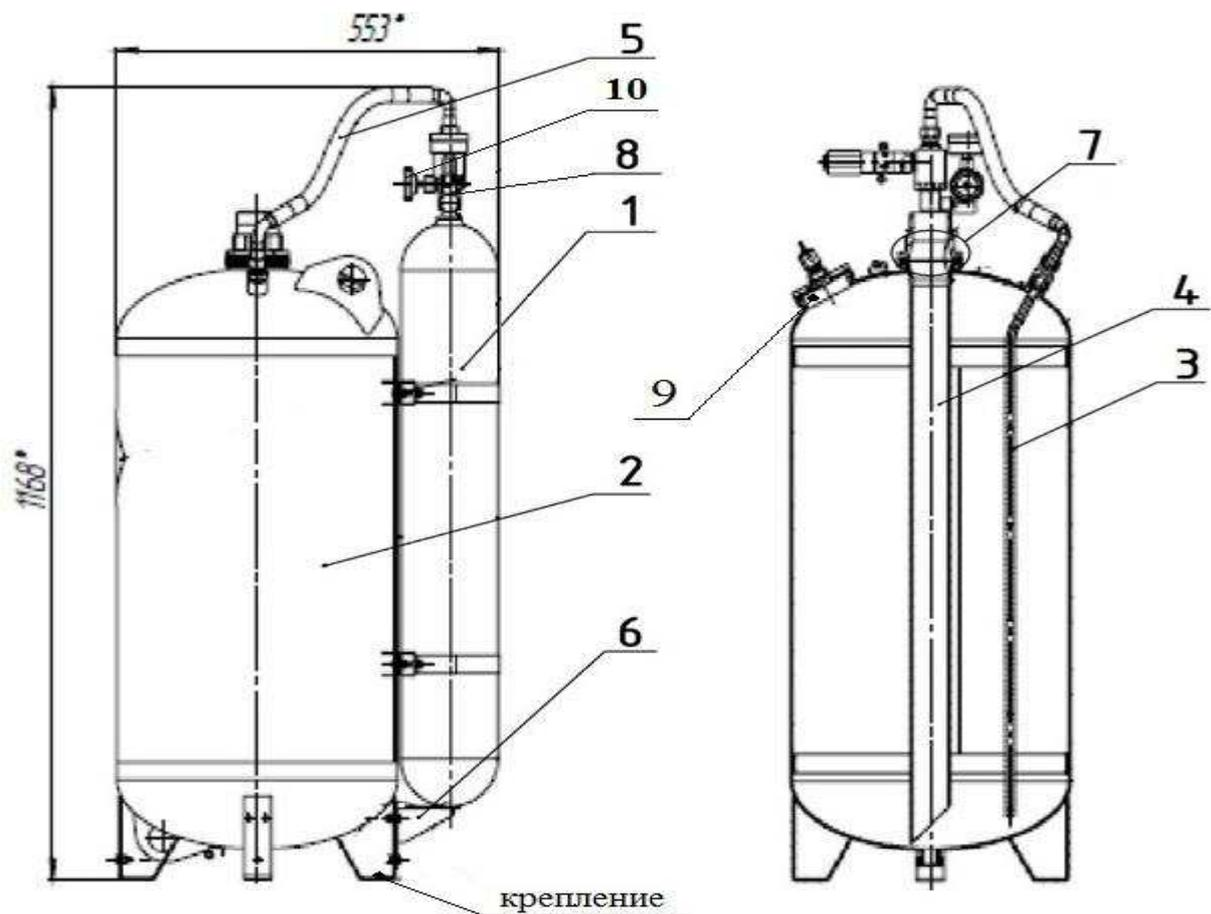
Рис.1 Модуль МПП-«Гарант-100вз» МПП(Н)-100-КД1-БСГ-УХЛ2 состоит из следующих основных элементов:
