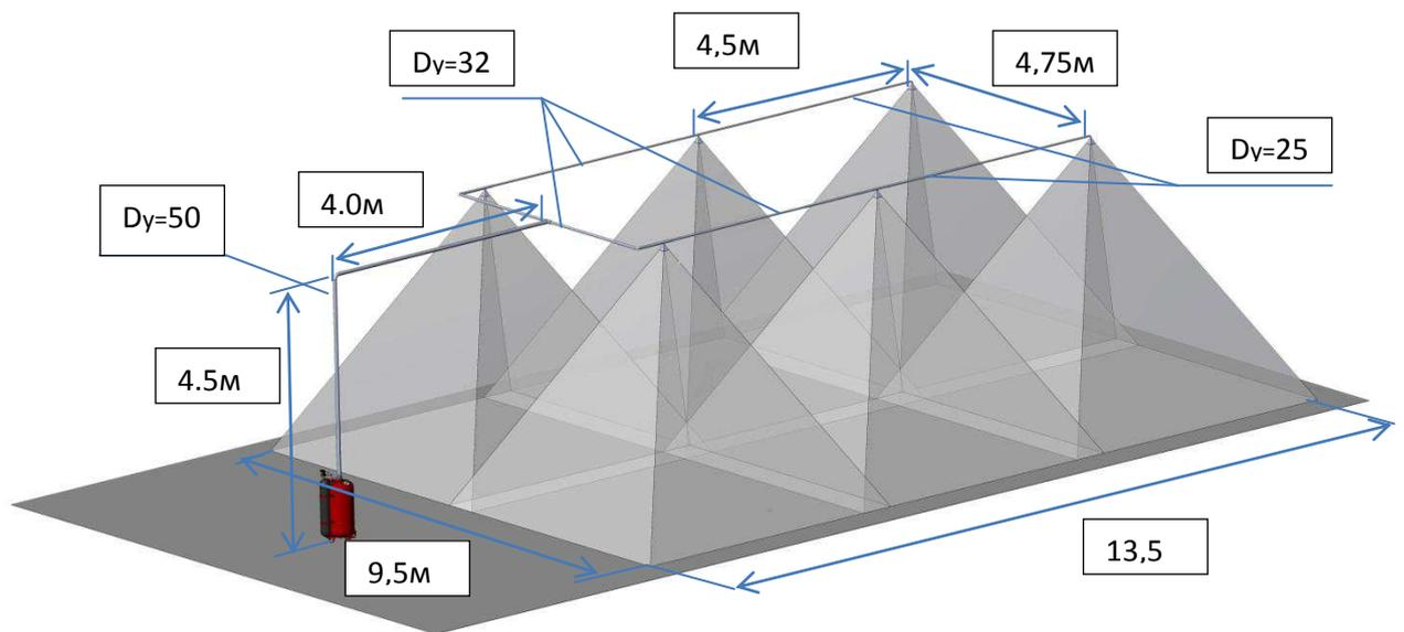
Рис.3. Варианты применения трубной разводки при использовании МПП-«Гарант-100вз».
