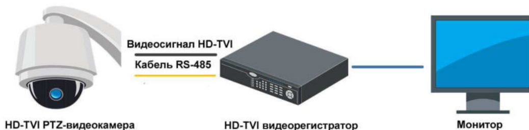
Рис. 1.9. Типичная схема управления через видеорегистратор
