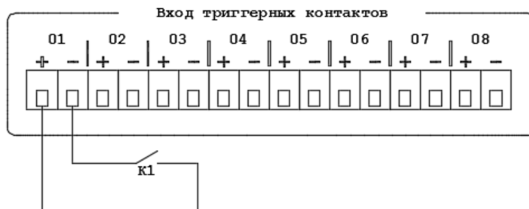
Рис. 3.5. Схема подключения внешних сигналов управления к LPA-DUO без контроля целостности.
