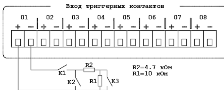
Рис. 3.4. Схема подключения внешних сигналов управления к LPA-DUO с контролем целостности
