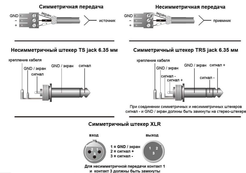
Рис. 4.1. Назначение контактов разъемов
