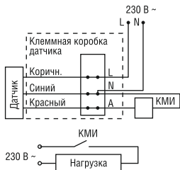
Рисунок 21 – Схема подключения датчика с контактором КМИ
