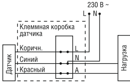
Рисунок 17 – Схема подключения датчиков типов: ДД-008, ДД-009, ДД-010, ДД-012, ДД-018В
