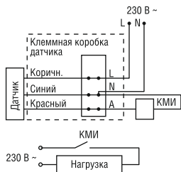
Рисунок 21 – Схема подключения датчика с контактором КМИ
