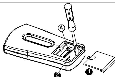
1. Снимите крышку отсека (сдвигается вниз).
