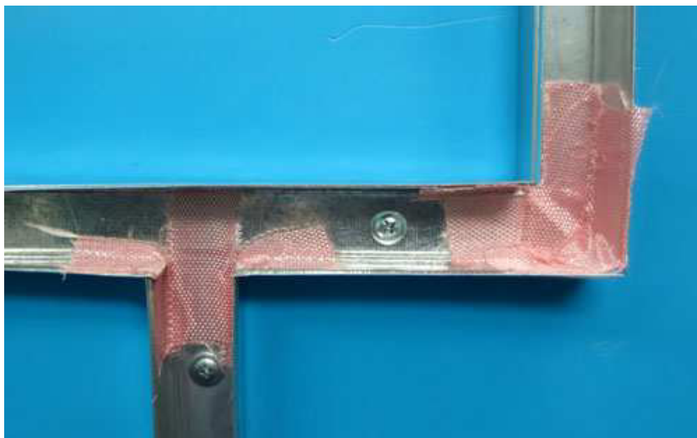
Рис. 17. Пример обработки резаных краев ККМО.
