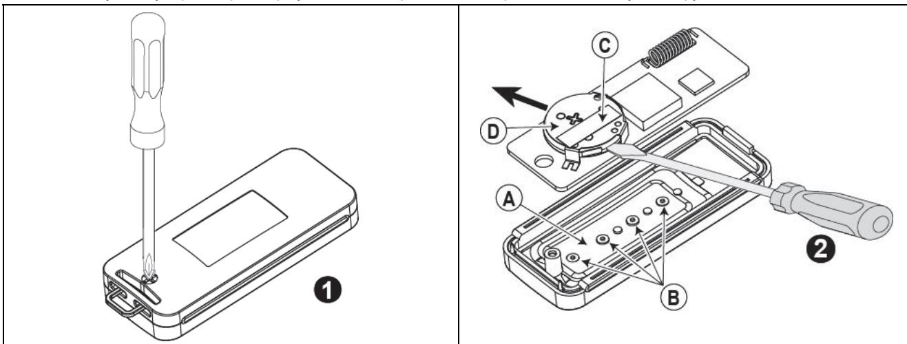
1. Открутите задний винт и раскройте корпус брелка.
