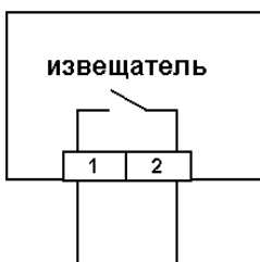
Рис.3а Под воздействием магнитного поля контакт 2 замыкается с контактом 1.
