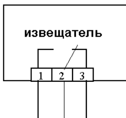
Рис.3б Под воздействием магнитного поля контакт 2 размыкается с контактом 3 и замыкается с контактом 1. Маркировка выводов: 1- красный (коричневый), 2- черный (зелёный), 3- синий (бесцветный)
