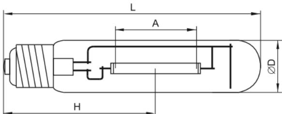
A – длина дуги; H – высота светового центра; D – диаметр колбы; L – полная длина.
