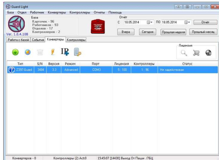
Конвертер **Z-397 Guard** должен быть переключен в режим «**Advanced**».
