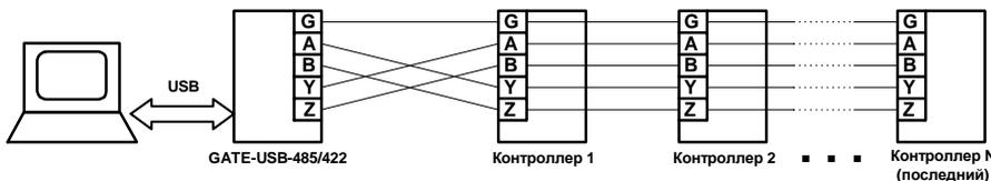
Оба типа интерфейса допускают только последовательный способ подключения устройств «от одного к другому». При подключении типа «звезда», «штаны», «Т-образное» часть устройств в линии может не работать из-за возникающей неравномерности распространения сигнала. Также на неравномерность распространения сигнала влияет правильное подключение оконечных резисторов «терминаторов» (120 оМ). В конвертере терминаторы подключены постоянно.
