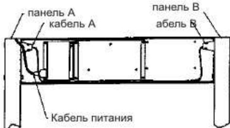
5. Используя оставшиеся винты и шайбы, соедините поперечную планку с боковинами, как показано на рисунке.
