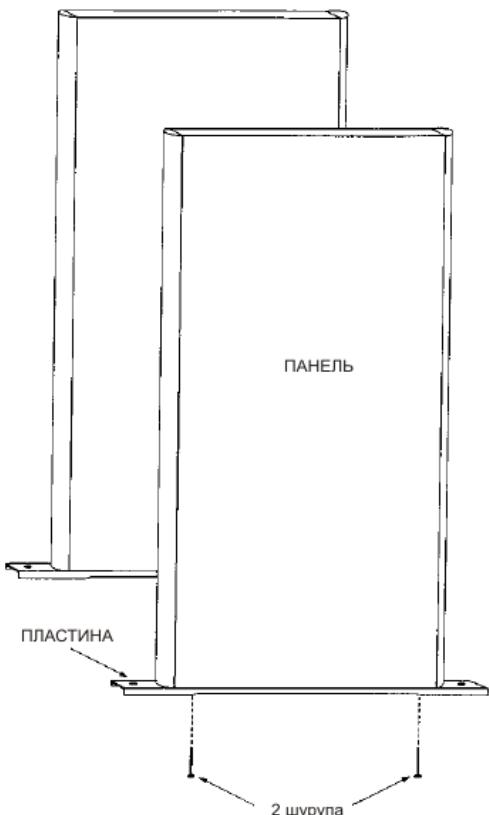
Внимание! Перед закреплением основания отрегулируйте ширину прохода (762мм) на уровне основания боковых панелей.
