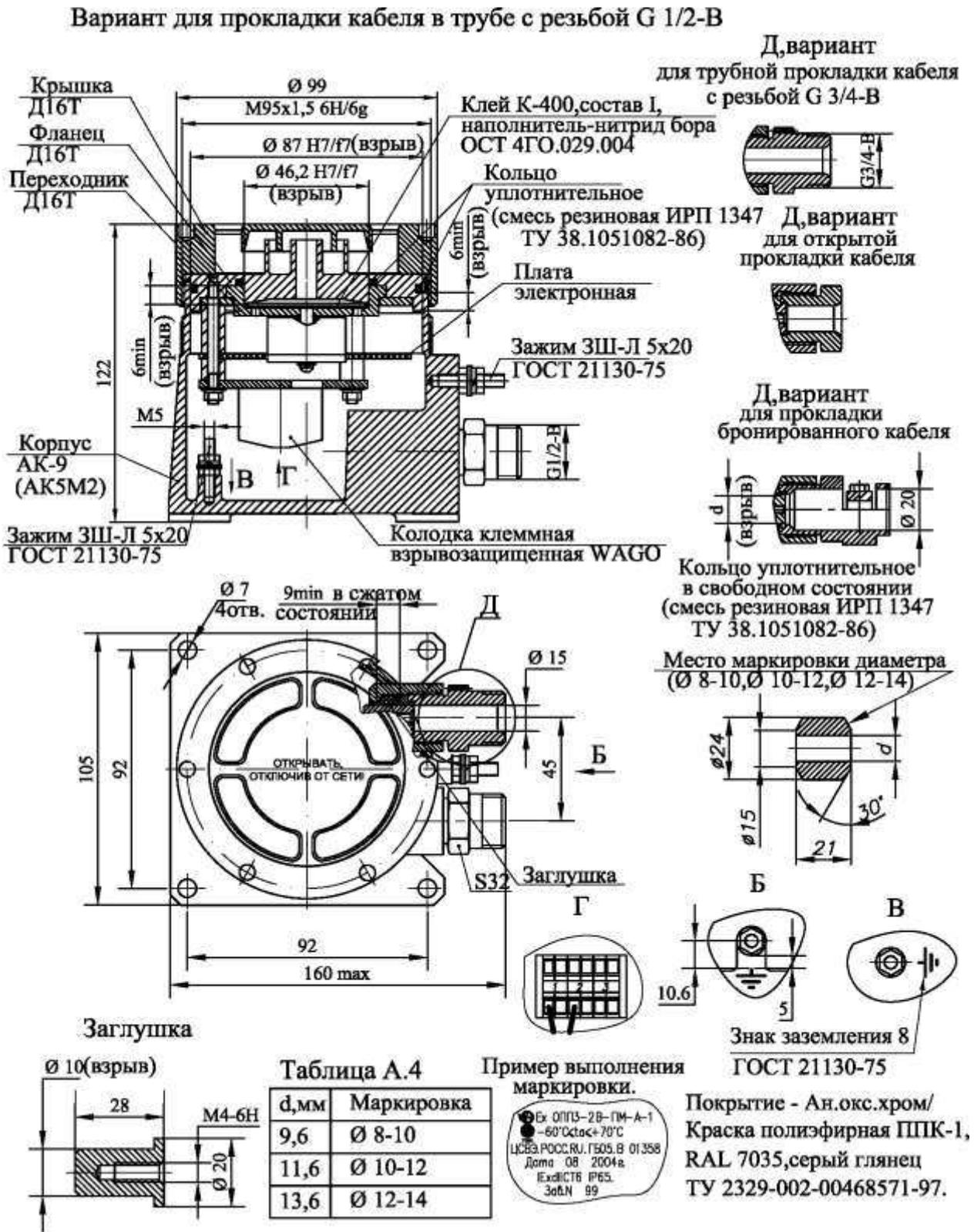
Рис. А.5 Габаритный чертеж звукового Оповещателя ExОППЗ-2В-Р в стальном корпусе, совмещённый с чертежом взрывозащиты
