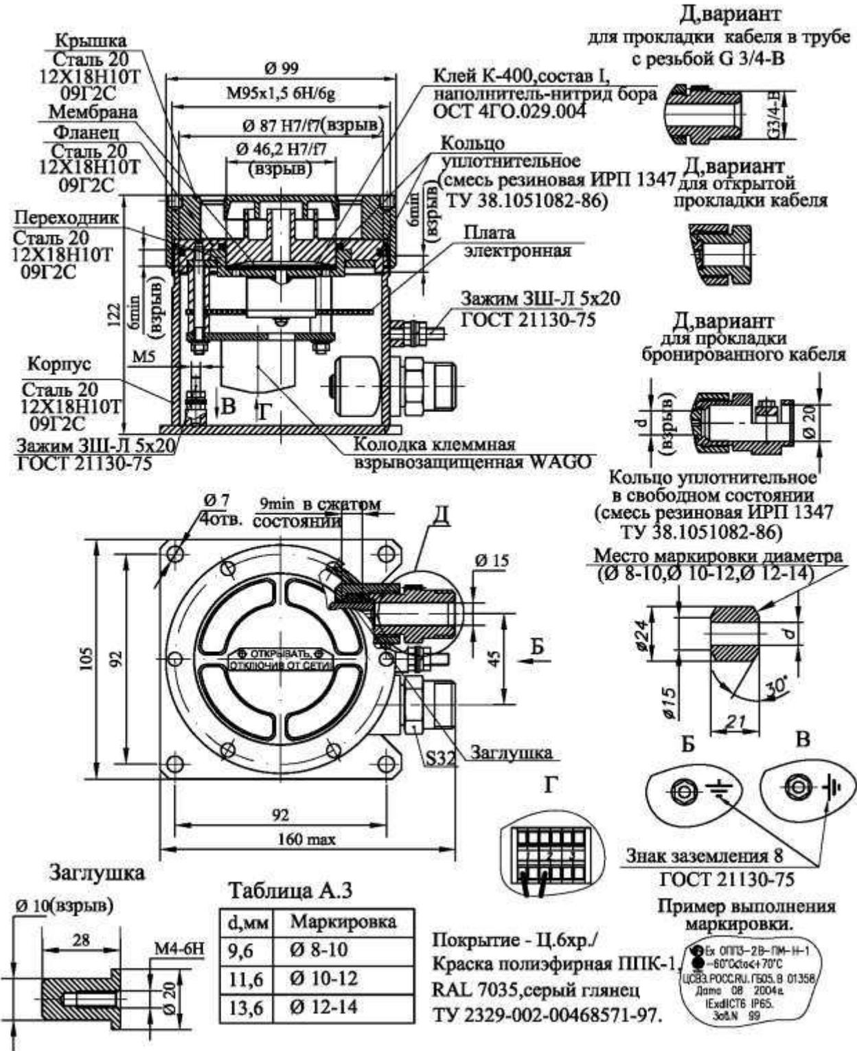
Рис. А.4 Габаритный чертеж звукового Оповещателя ExОППЗ-2В-ПМ в алюминиевом корпусе, совмещённый с чертежом взрывозащиты
