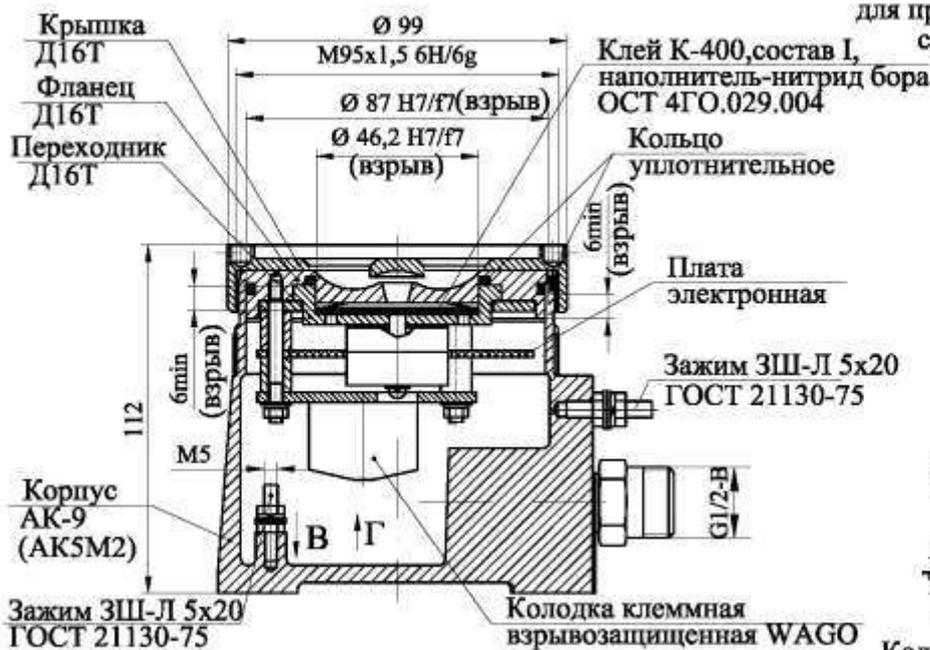
Д,вариант для прокладки кабеля в трубе с резьбой G 3/4-B
