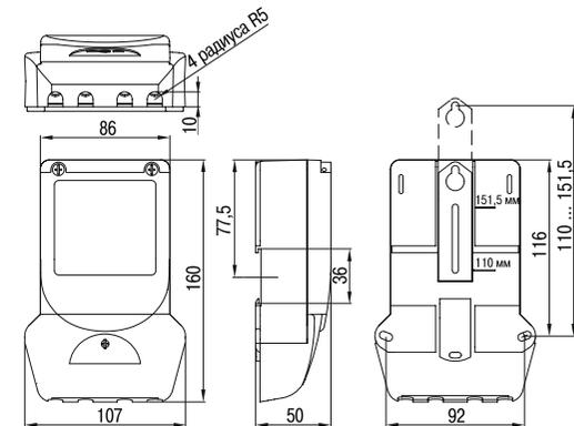
Рисунок 5 – Габаритные и присоединительные размеры счётчиков габарита корпуса 3
