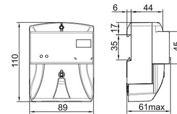
Рисунок 3 – Габаритные и присоединительные размеры счётчиков габарита корпуса 5
