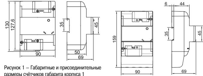
Рисунок 1 – Габаритные и присоединительные размеры счётчиков габарита корпуса 1
