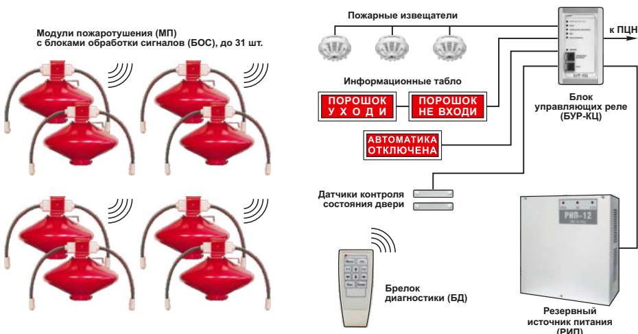
Рис. 4.5. Структурная схема АУП «Гарант-Р» ПО-2 МС
