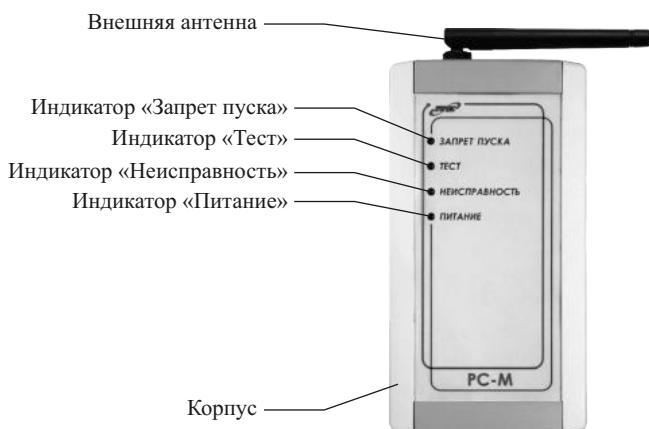
Рис. 6.3. Внешний вид РС-М
