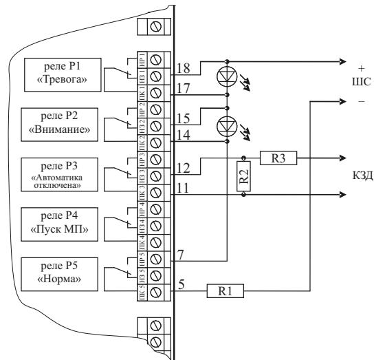
где:  $R1=365\text{ Ом}$ ;  $R2=6,1\text{ кОм}$ ;  $R3=100\text{ Ом}$ ;  $VD1, VD2 - \text{АЛ 307 А (В, АМ)}$ .
