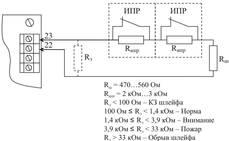
Схема подключения датчиков закрытия дверей к БУР.
