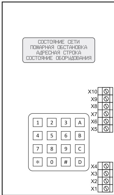
Рис. 6.13. Схема расположения индикатора, органов управления и клемм для внешних подключений на плате КП-RS
