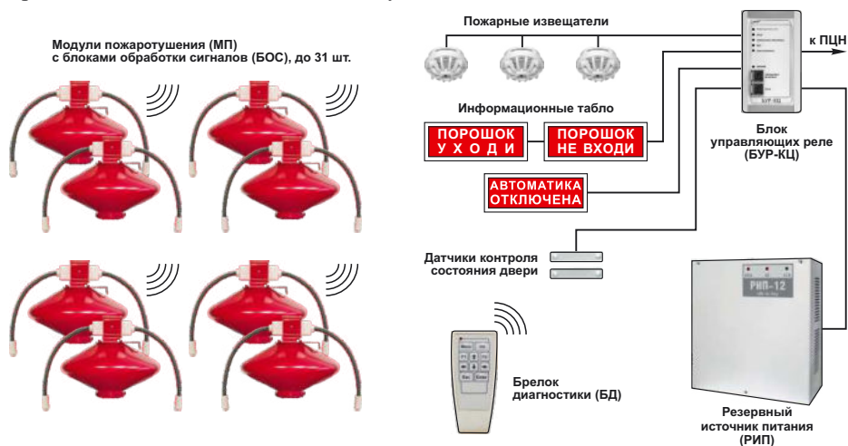
Рис. 4.5. Структурная схема АУП «Гарант-Р» ПО-2 МС
