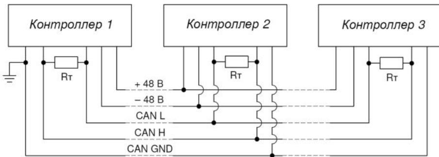
Рисунок 6 Схема соединение шины CAN с одним уравнивающим проводом
