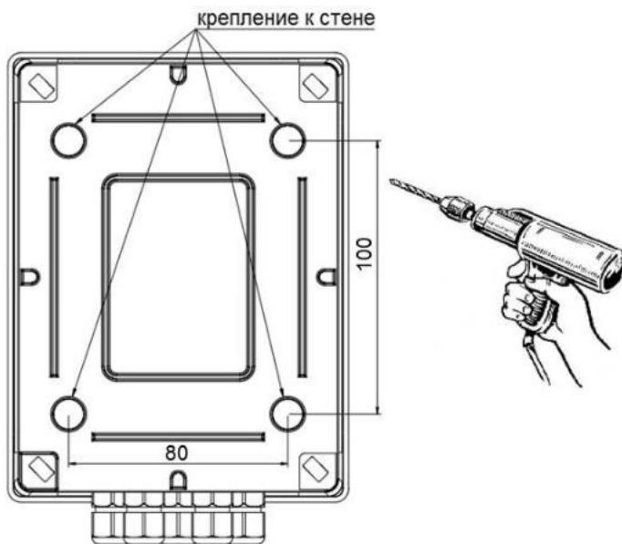
Рисунок 4 Установка СК на объекте
