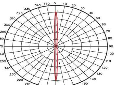
Рис.2 Диаграмма направленности антенны AT-5.8/Omni(12) в горизонтальной и вертикальной плоскости.
