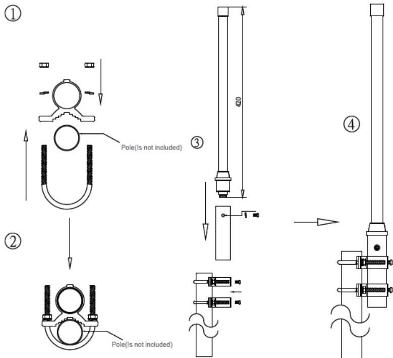
**Пошаговое подключение антенны AT-5.8/Omni(12). к беспроводному передатчику/приёмнику, работающем на частоте 5.8 ГГц.\***
