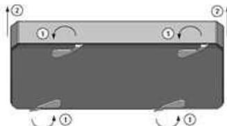
2. Вклацнути опору в корпус світильника.
