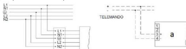
3. Схема підключення світильника до мережі живлення з регульованим драйвером за системою 1-10 V або системою DALI.
