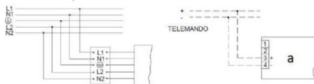
3. Схема подключения светильника к питающей сети с регулируемым драйвером по системе 1-10 V или системе DALI .
