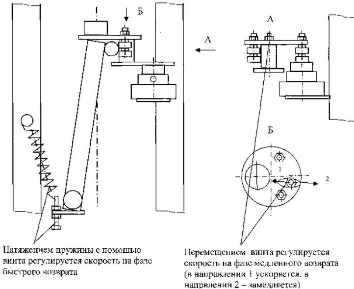
Потяжением пружины с помощью винта регулируется скорость на фазе быстрого возврата
